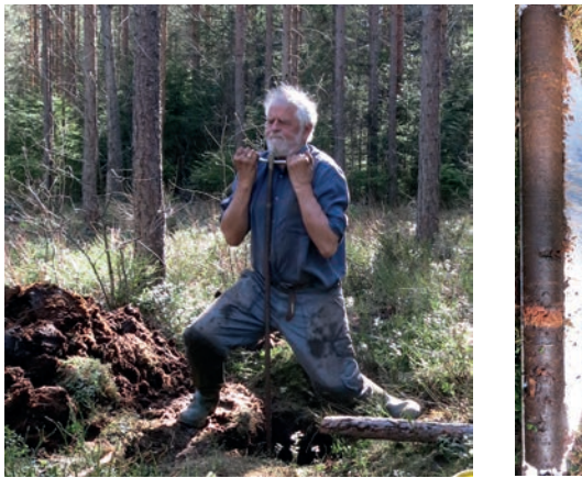
Figur 3. Prøvetaking i myr kan være hardt arbeide. Helge I. Høeg presser knivboret ned i torva. Høyre bilde: Prøver fra myra tatt med «knivboret» som samler en halv-sylinder med 7 cm diameter og 75 cm lengde. Denne prøven er fra ca. 3 m dyp. Fast brun torv øverst, deretter mørk torv blandet med slam (gytje) over en råttan furustokk, og underst mørk torv med trebiter og innblandet slam. Undre del av denne kjernen er radiokarbon-datert, og det ga en alder på 6725 \pm 75 år før nåtid. Foto: Rolf Sørensen.
